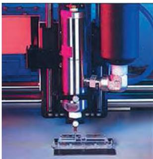
Применяется для очень вязких материалов (20 ксПз и выше), таких как: силиконы, густые смазки, монтажные клеи, цианакрилатные клеи
