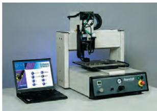
Автоматы дозирования серии DispenseMate® предназначены для нанесения различных видов
