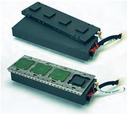
Контактный нагрев для заливки FlipChip
