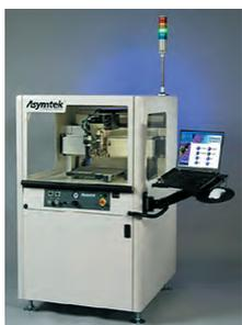
Автомат дозирования Spectrum® S-820 предназначен для нанесения различных видов технологических материалов, применяемых в радиоэлектронной промышленности, включая паяльные пасты, клеи,
