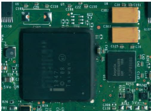
**Применение технологии Dam&Fill для заливки кристалла микросхем, FlipChip Underfill**
