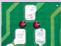
Нанесение клея под поверхностный монтаж
