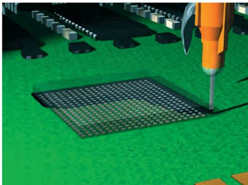
**ПУ: Высокой насыщенности. Используются чип элементы 01005, uBGA, PoP, FlipChip микросхемы с шагом 0,3 мм**
