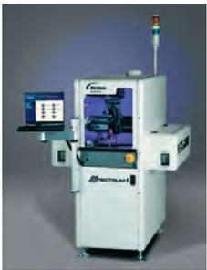
Современное поколение конвейерных установок Asymtek Spectrum II имеет узкую базу, которая минимизирует занимаемую площадь. Идеально подходит для нане-
