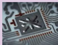
Нанесение электропроводящих клеев для монтажа кристаллов
