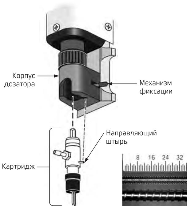
Шнеки могут быть с разным шагом винта, что позволяет работать как с пастами 3 типа, так и с пастами с более мелким размером частиц. Чем меньше шаг шнека, тем меньше доза пасты может быть получена. При этом очень важным является зазор между шнеком и стенками канала, по которому подается паста. Он должен быть таким, чтобы шарики пасты не продавливались в обход витков шнека, что может привести к подтеканию пасты и блокировке его вращения.
